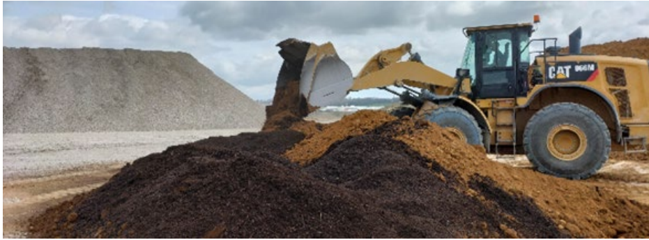
Figure 30 : Exemple d'opération de mélange au chargeur sur un site de fabrication (Source PHV)
